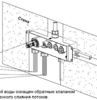
Откройте крышку присоединительной коробки и убедитесь в отсутствии утечки воды. После завершения подсоединения трубопровода, подайте воду под давлением 0,5–1,2 МПа на оба патрубка холодной и горячей воды и тщательно проверьте соединения. В трубопроводе не должно быть утечек воды, время проверки должно составлять не менее 5 минут.
