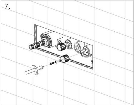
8. Установите кнопку с символом на корпус и отрегулируйте высоту. Установите крышку, чтобы проверить соответствие требуемой высоты кнопки. Рекомендуемая высота кнопки от панели 5 мм.
