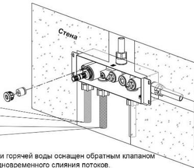
Откройте крышку присоединительной коробки и убедитесь в отсутствии утечки воды. После завершения подсоединения трубопровода, подайте воду под давлением 0,5–1,2 МПа на оба патрубка холодной и горячей воды и тщательно проверьте соединения. В трубопроводе не должно быть утечек воды, время проверки должно составлять не менее 5 минут.
