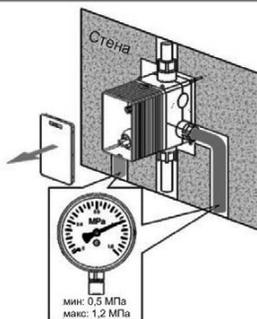
Откройте крышку короба и убедитесь в отсутствии утечки воды. После полного подключения трубопровода, подайте давление воды 0,5-1,2 МПа на оба патрубка холодной и горячей воды и тщательно проверьте соединения. В трубопроводе не должно быть утечек воды, время проверки должно быть не менее 5 минут.
