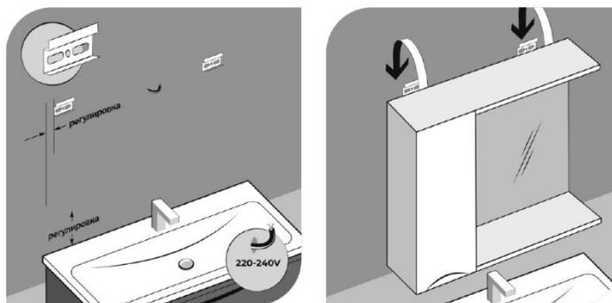
1. Соедините провода системы электроснабжения с клеммником, расположенным на тыльной стороне шкафа зеркального.
